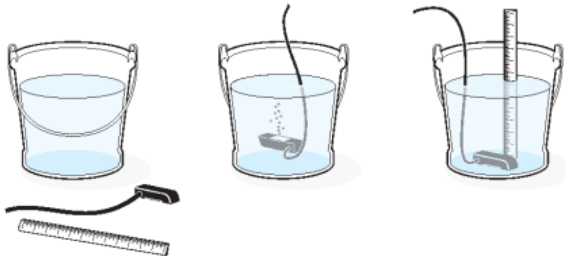
图 18 校准浸入式面积/速率传感器
